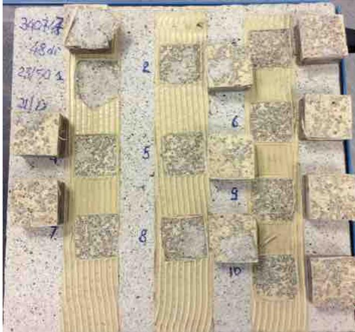
**Provette a fine prova - condizionate con sequenza 4.2.5.1**
